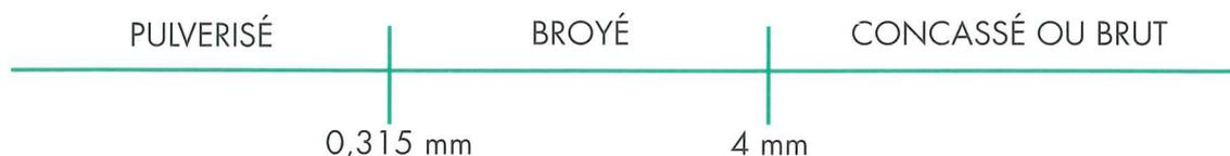
Dans la classe des pulvérisés, le degré de finesse s'exprime par un pourcentage de passage au travers d'un tamis de 0,16 mm puis de 0,08 mm.
