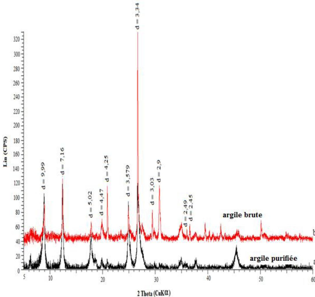
Figure 2. Analyse diffractométrique de l'argile brute et l'argile purifiée.
