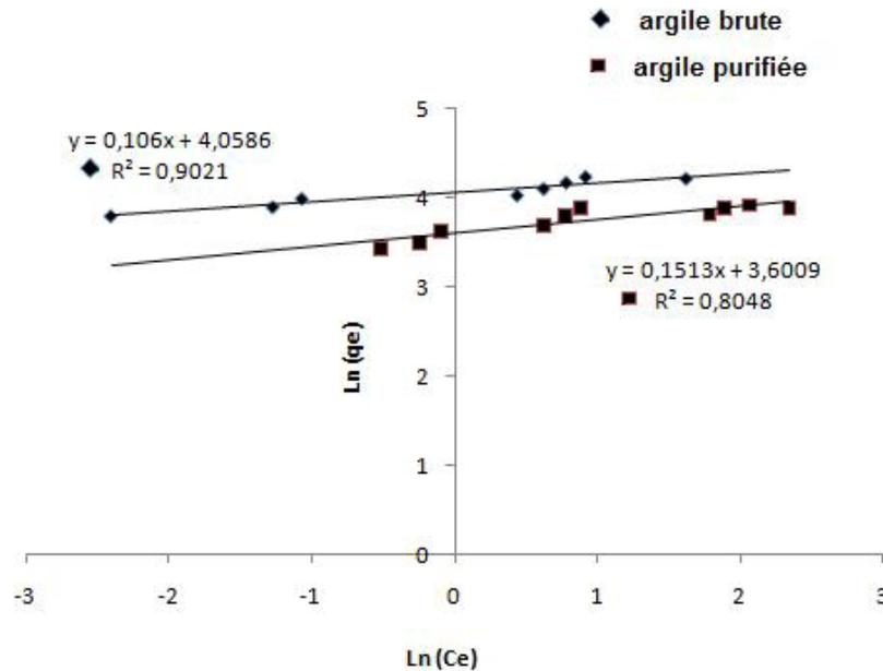
Figure 11. Isotherme de Freundlich de l'adsorption du bleu de méthylène sur l'argile brute (◆) et l'argile purifiée (■).
