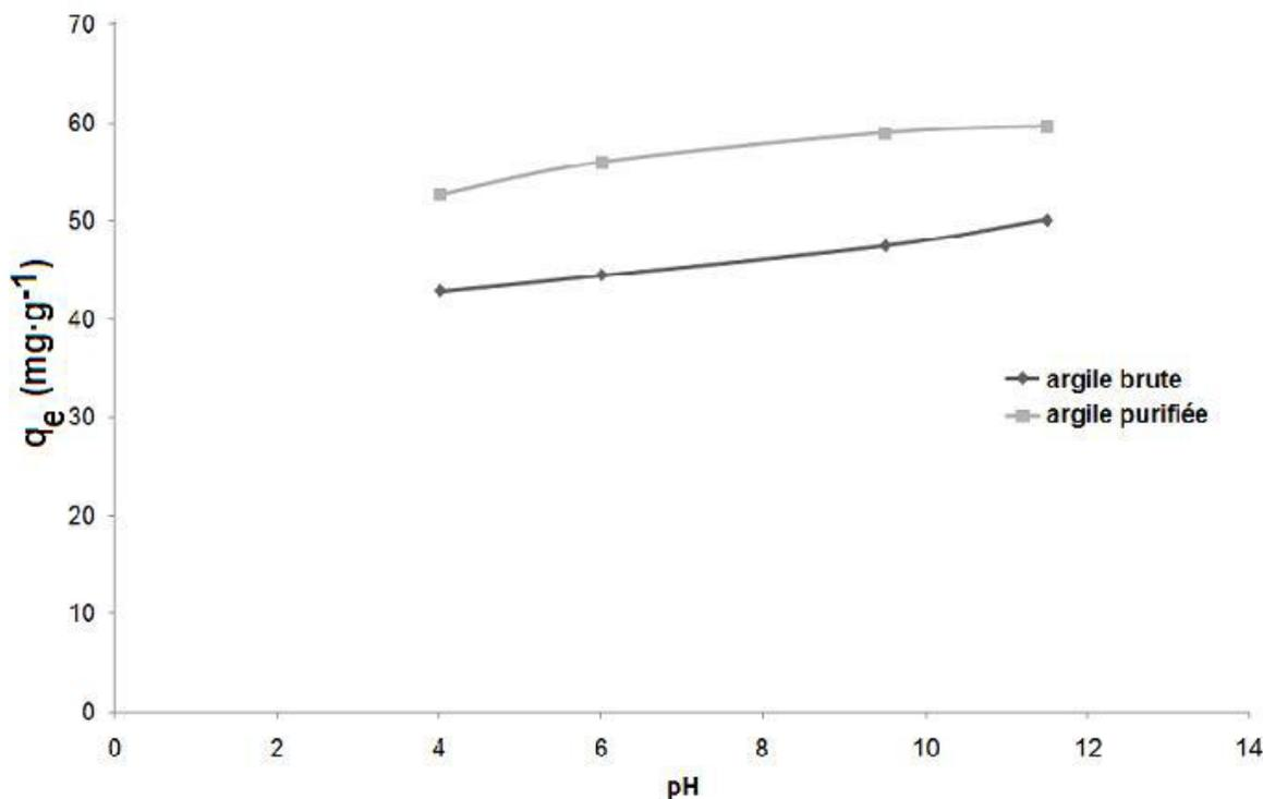
Figure 6. Influence du pH de la solution sur l'adsorption du colorant bleu de méthylène sur l'argile brute et purifiée.
