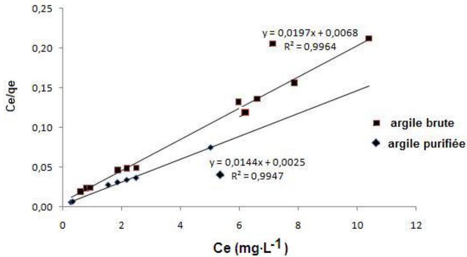
Figure 10. L'isotherme de Langmuir pour l'argile brute (■) et l'argile purifiée (◆).
